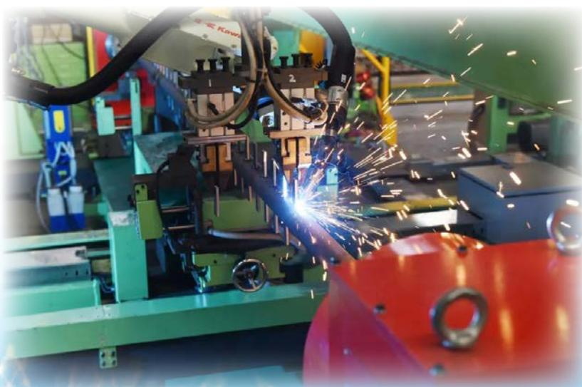
國內鍋爐行業首套吊掛管智能化焊接生產線在鍋爐公司成功投入使用。鍋爐公司成為國內鍋爐行業內唯一實現了吊掛管從原材料上料到焊接成型下料的自動化生產流水線、唯一實現了吊掛管自動化焊接數據採集的功能、唯一實現了吊掛管適用材料形式多樣的自動化焊接的企業。
